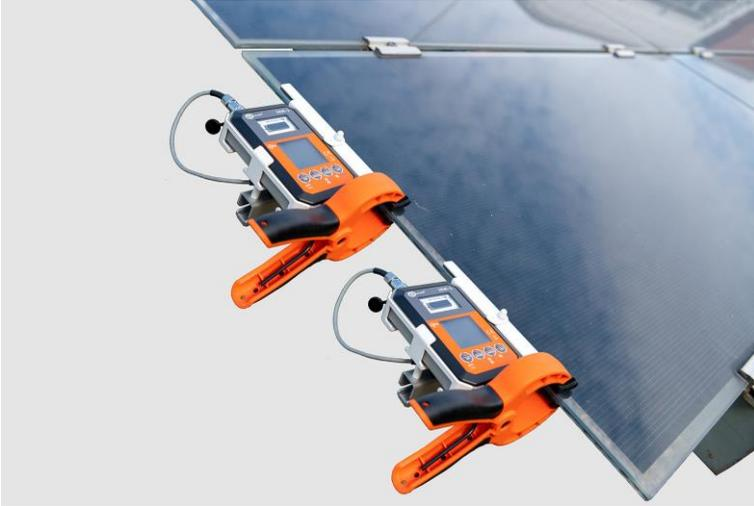
**1** Empareje medidores de temperatura y luz solar con el dispositivo.
